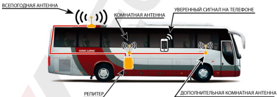
Схема №1. Пример установки репитера в автобусе.
