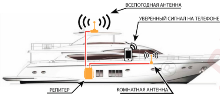
Схема №2. Пример установки системы усиления сотового сигнала на яхте.
